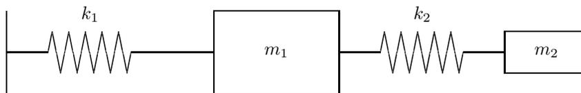
Choisir les variables (coordonnées horizontales) telles que  $x_1 = 0$  et  $x_2 = 0$  correspond à la situation des deux masses au repos. On applique une force horizontale  $f(t)$  sur la première masse.
