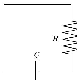
La capacitance est déchargé pour des temps  $0 \leq t < \infty$  par la résistance. La tension est donnée par la formule ci-dessus.
